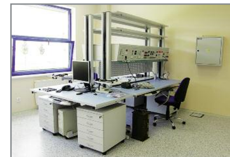
Pracovní ostrov v antistatickém provedení s boční pracovní deskou bez nohou se zavěšenými elektronástavbami, policemi a deskou na nářadí, ZAT Plzeň
